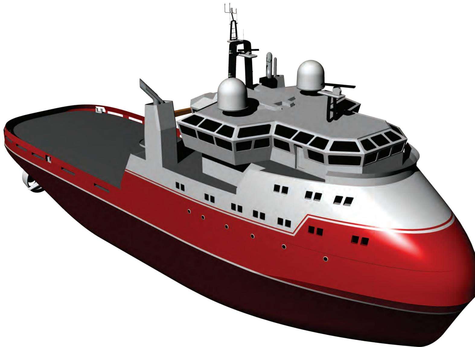
Queste imbarcazioni sono progettate per la gestione delle ancore delle piattaforme petrolifere, per il traino e il posizionamento di quest'ultime e, in alcuni casi, per fungere da Emergency Rescue and Recovery Vessel. Sono utilizzati anche per il trasporto di rifornimenti e di impianti di perforazione.
