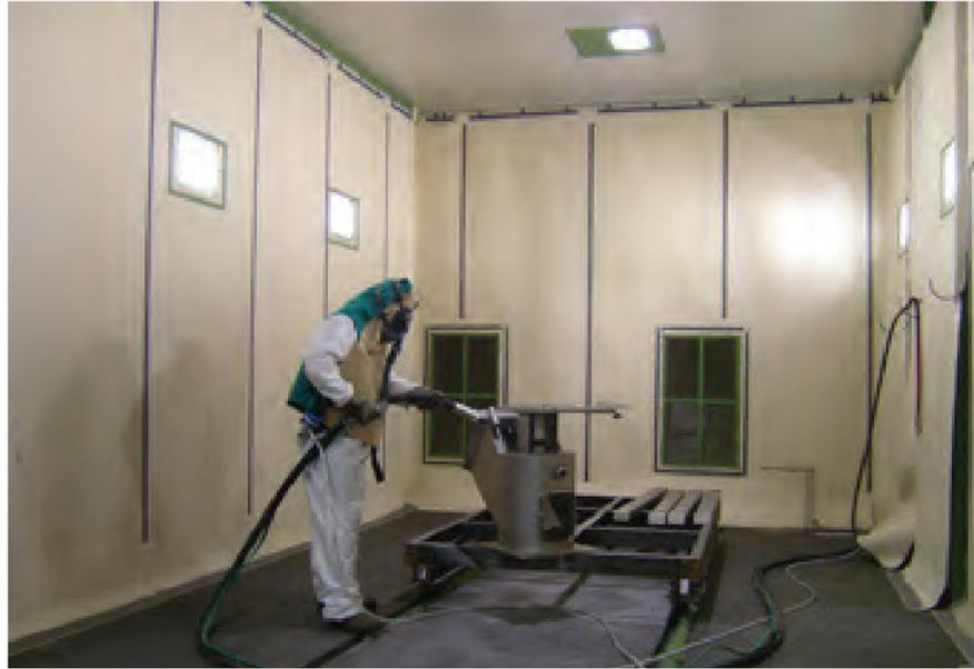
Metodo di preparazione e pulizia delle superfici di acciaio prima della pittura o dell'applicazione di uno strato protettivo contro la corrosione.
